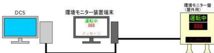
施設内の発電量データを分散形プロセス制御システム（DCS）から取得して、パソコン画面に表示しデータロギングを行います。
