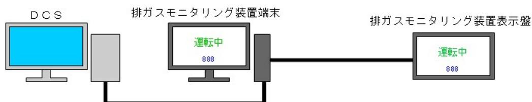
ゴミ焼却場内炉の運転状況や各種計測データを分散形プロセス制御システム（DCS）から取得して、端末の画面に表示します。また取得データのグラフ化も行います。近隣住民への案内用電光掲示板の製作も可能です。
