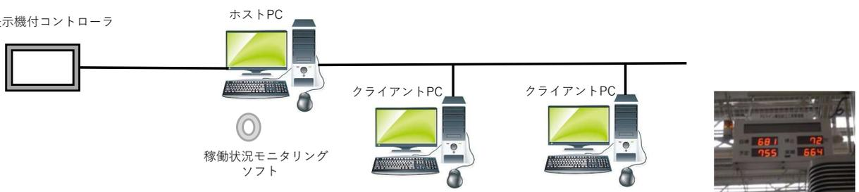
生産ラインの稼働状況を制御機器(表示機付コントローラ)から取得して一覧表示を行います。取得したデータを元にライン毎の生産状況をグラフ表示します。またネットワーク上の別パソコンで表示します。大型アンドン表示板の製作も可能です。
