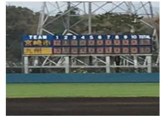
大型の野球用スコアボードの当社製作範囲はチーム名部分、得点部分、BSOカウント部分などのLED表示部分です、躯体、設置、配線は別途お手配ください
