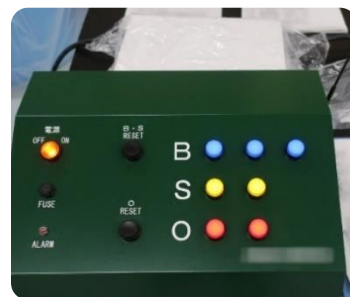
スコアボード制御装置
